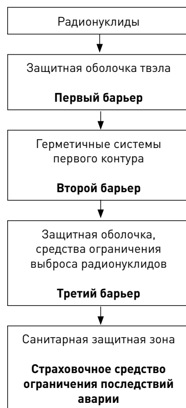
Рис. Л3. Схема барьеров на пути распространения радионуклидов, генерируемых в процессе работы ЯЭУ
