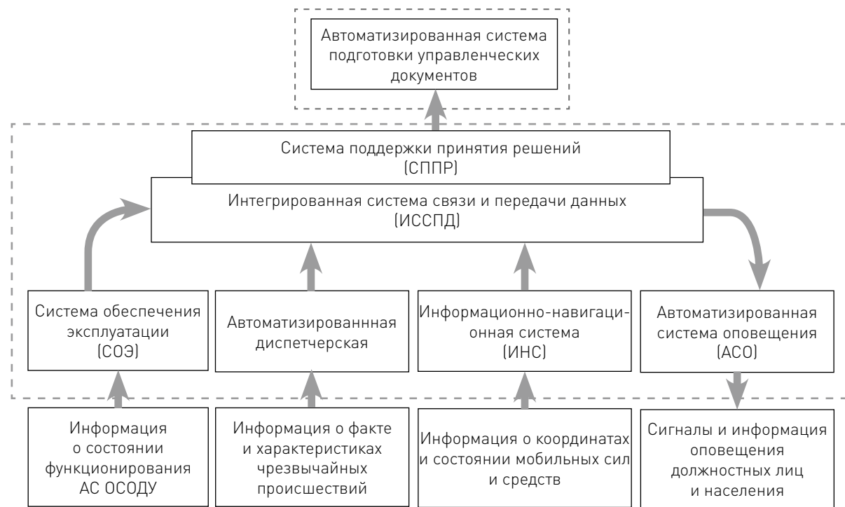
Рис. А1. Основные функциональные и обеспечивающие системы АС ЕДДС
